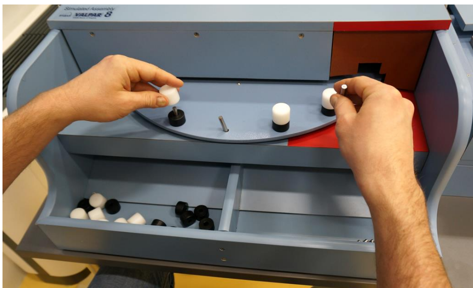
Rysunek 15. Próba pracy do oceny zdolności wykonywania pracy montażowej na taśmie.
